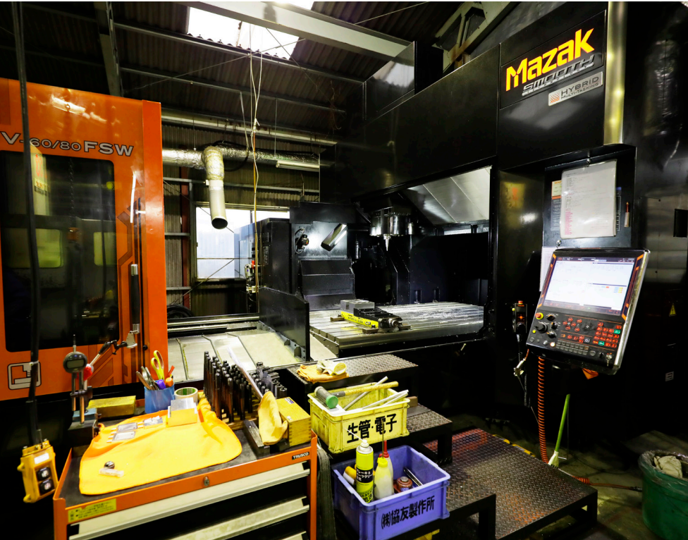
導入したFSWとマシニングセンタ機能を持つ設備
