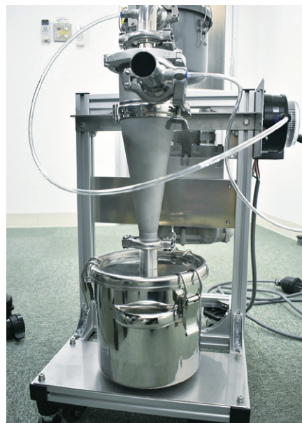
▲補助事業の成果をもとに製作した金属製サイクロン
