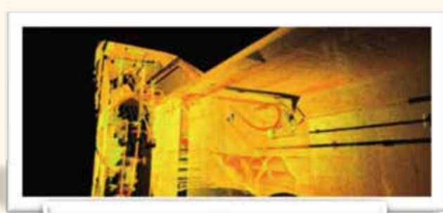
矩形トンネル内にある配管類の3D点群データ
