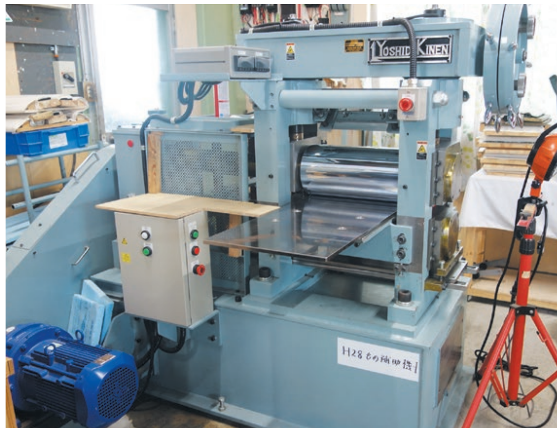
補助金で導入した圧延機。幅は40cm、薄さは約0.4mmまでの圧延が可能に
