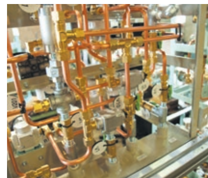
配管のコンパクト化により省スペースを実現した制御装置
