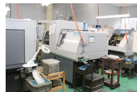
小さい部品を製造する 複合加工機
