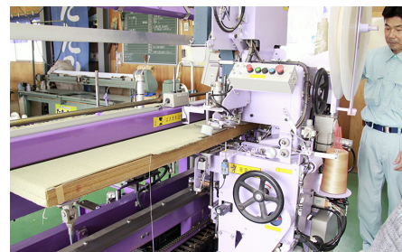
畳縁の縫着と幅寸法の縫断を行う返縫機
