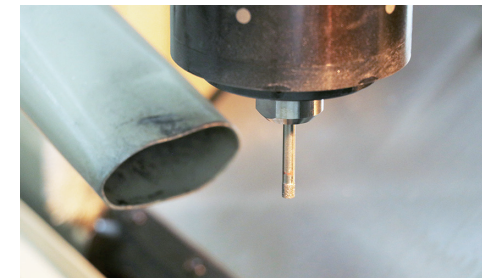
● 先端にダイヤモンド粒の砥石が付いた軸が超高速回転し、金型に穴加工する
