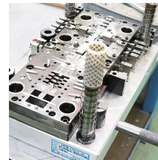
● 高精度な穴加工が施されたプレートの金型。この金型に帯状の金属を通すと、左ページの写真のような端子部品ができる
