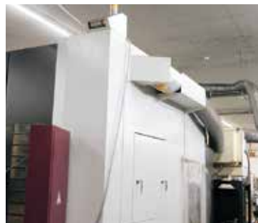
NC加工機に取り付けられた油除去ダクト
