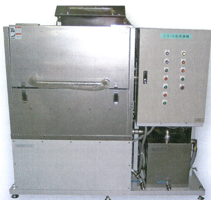
完成した高圧温水自動洗浄装置
