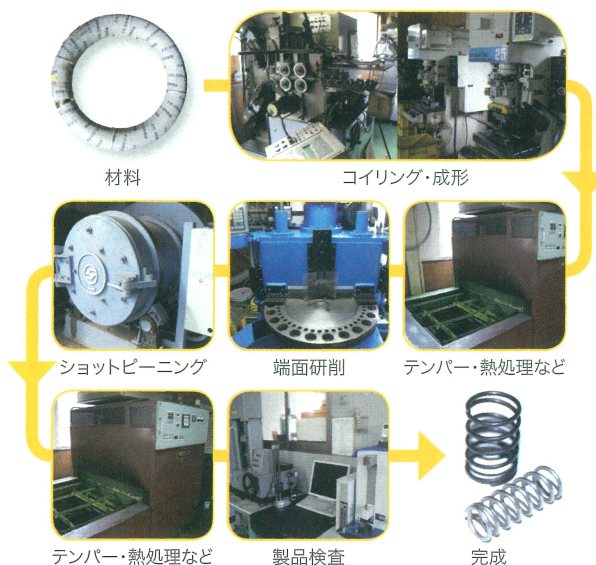
POINT1：ばねの製造工程（社内一貫生産体制）
