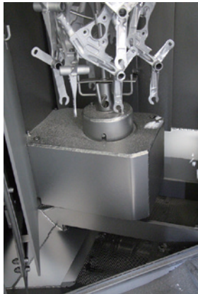
ステーションの下にある、特注のインバーター制御。インバーター制御を取り入れたことで、ステーションの回転速度を調整できるようになった
