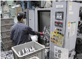
木の枝のような形のラックに部品を吊るし、回転させながらショット玉を投射するハンガー式ショット機
