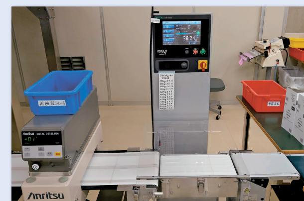
検査機は1台で計量・金探に対応
