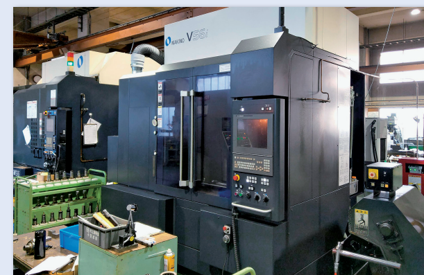
導入したマシニングセンターはHRC50-60の鋼材も切削加工可能
