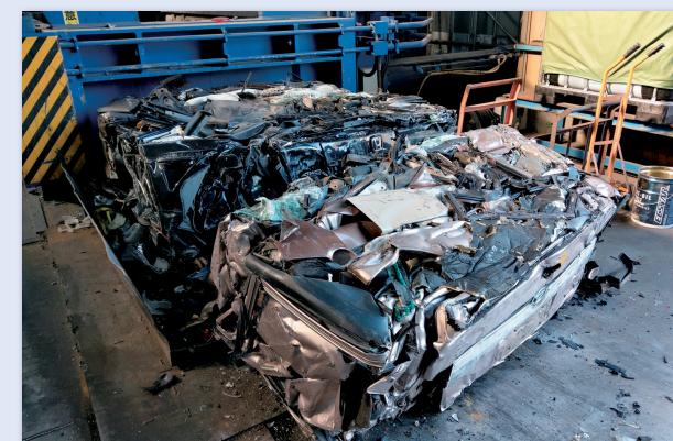
プレス後の残さは電解炉へ投入可能なサイズとなった
