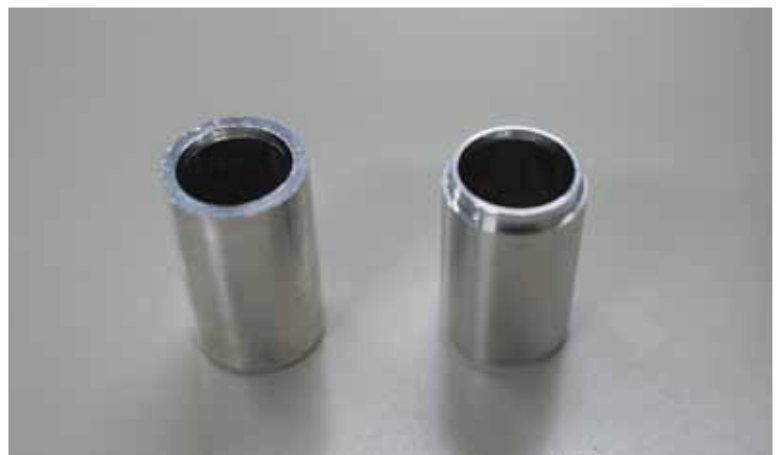
圧造品(左)に仕上げ加工を施し完成する(右)
