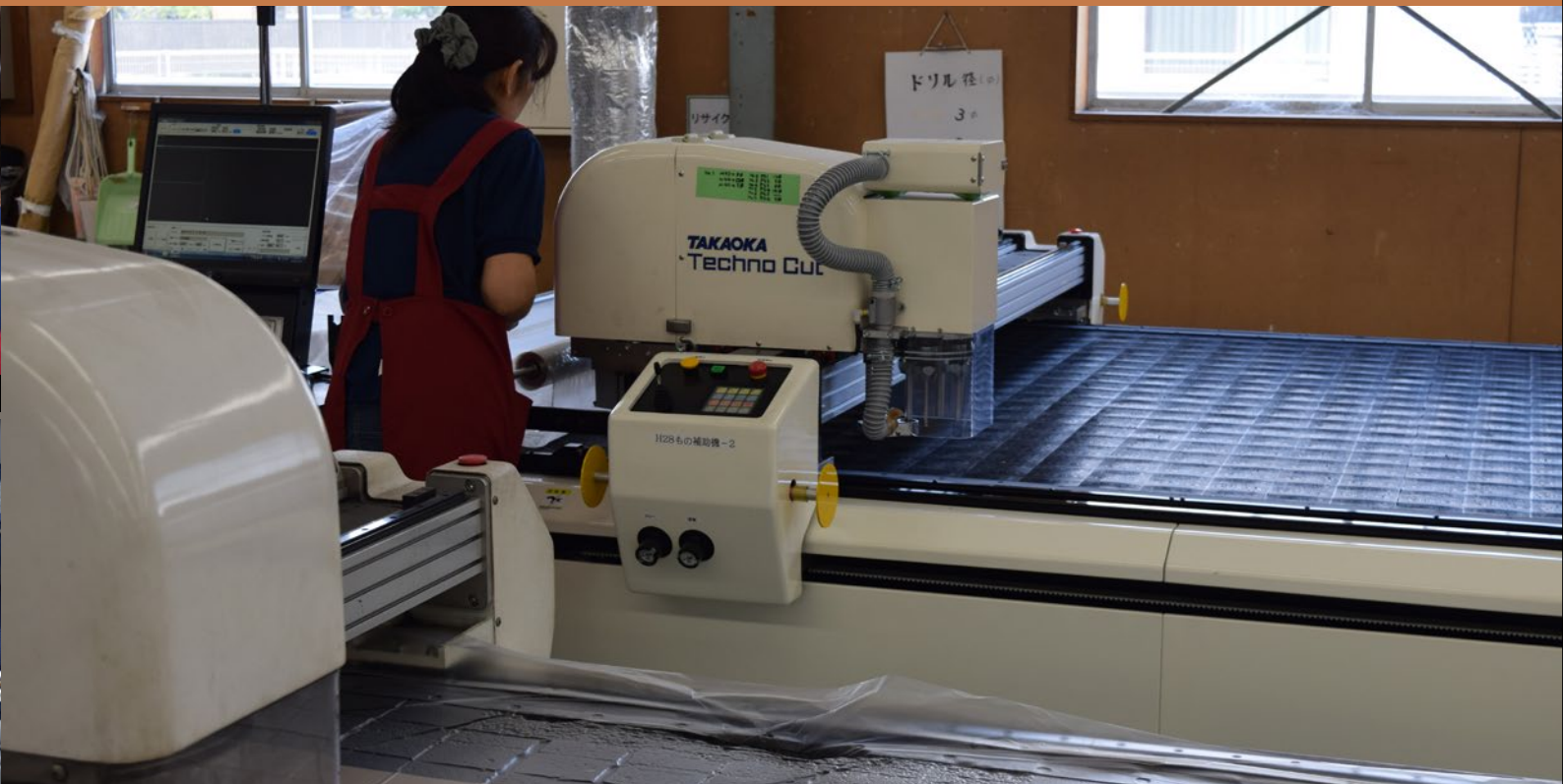
新たに導入した最新鋭のNC裁断機。精密な裁断ができ、歩留りや生産性が向上した
