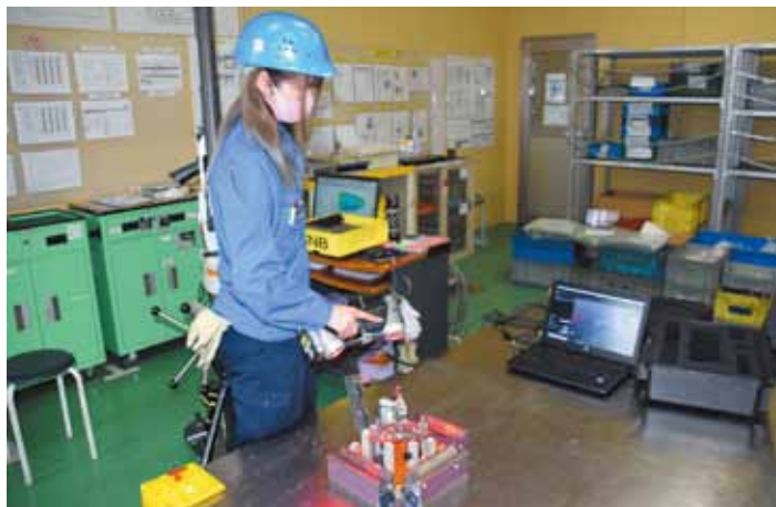
ハンディスキャナーは現場で金型などの測定ができ、工程の効率化につながった
