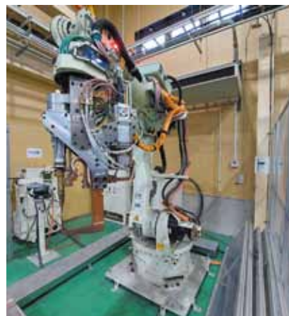
ロボットアームの配線を「見える化」し故障の予兆などに迅速に対応する
