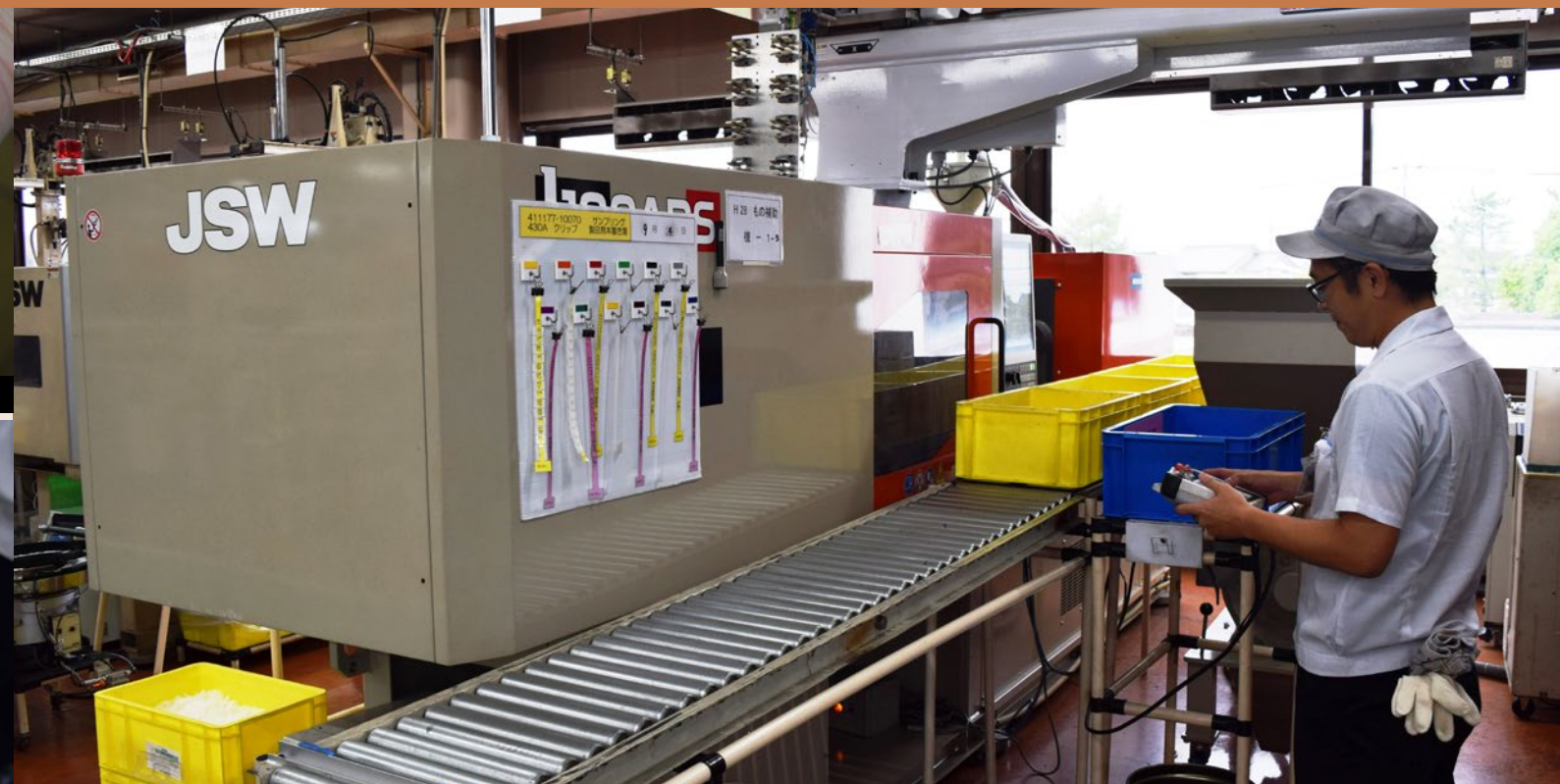
油圧式から電動式に変更してネットワーク接続。稼働状況や成形条件などの把握が可能なシステムを構築した
