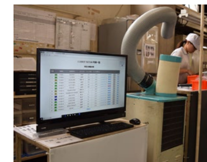
IoT化した全成形機の稼働状況を現場でも表示
