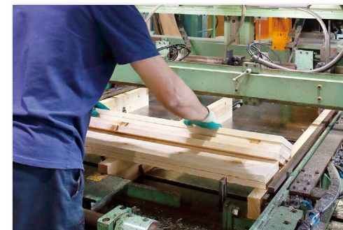
②釘打機に材料（木材）をセッティングする
