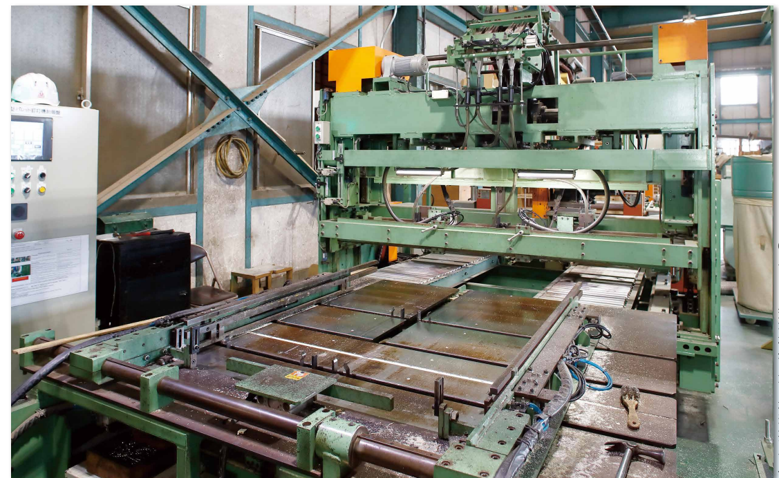
①パレット釘打機（前景：材料投入口）
