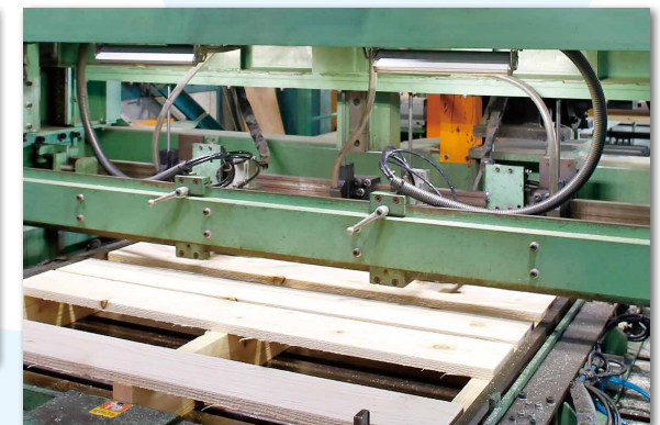
③釘打機が手前に移動し正確な位置に釘打ちする
