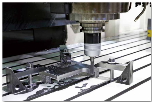
門型マシニングセンタで角型部品を加工中
