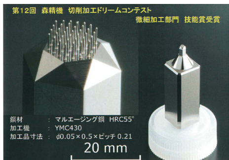
コンテストで受賞した微細部品加工例
