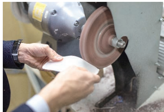
研磨作業（工程4）
