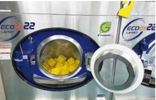
【スポンジボールを入れた洗浄機】
