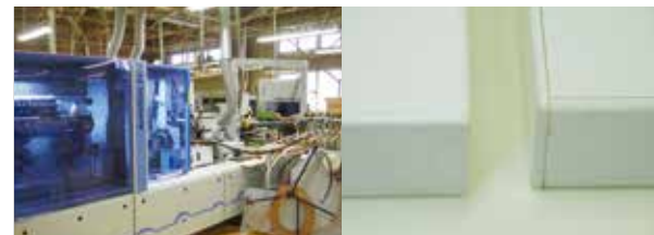
【エッジバンディングマシン「KAL370 Ambition2474/airTec」】 【木口の仕上げ(左)本取組の設備使用、(右)従来の設備使用】
