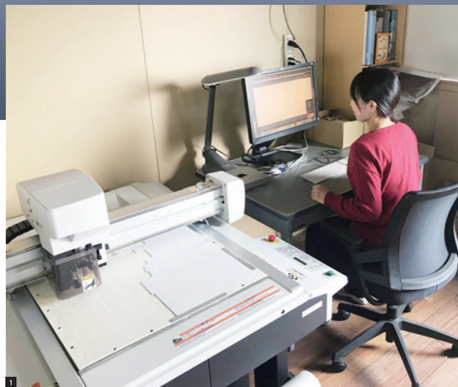
1、2 パッケージの展開図をデザインしたパソコンと繋げることで、木型を作らなくても包装材を切り出してくれるカッティングプロッタ 3 学校や楽団などに好評の「楽譜整理ケース」(奥)と、カッティングプロッタで作った小ロットの包装材(手前)
