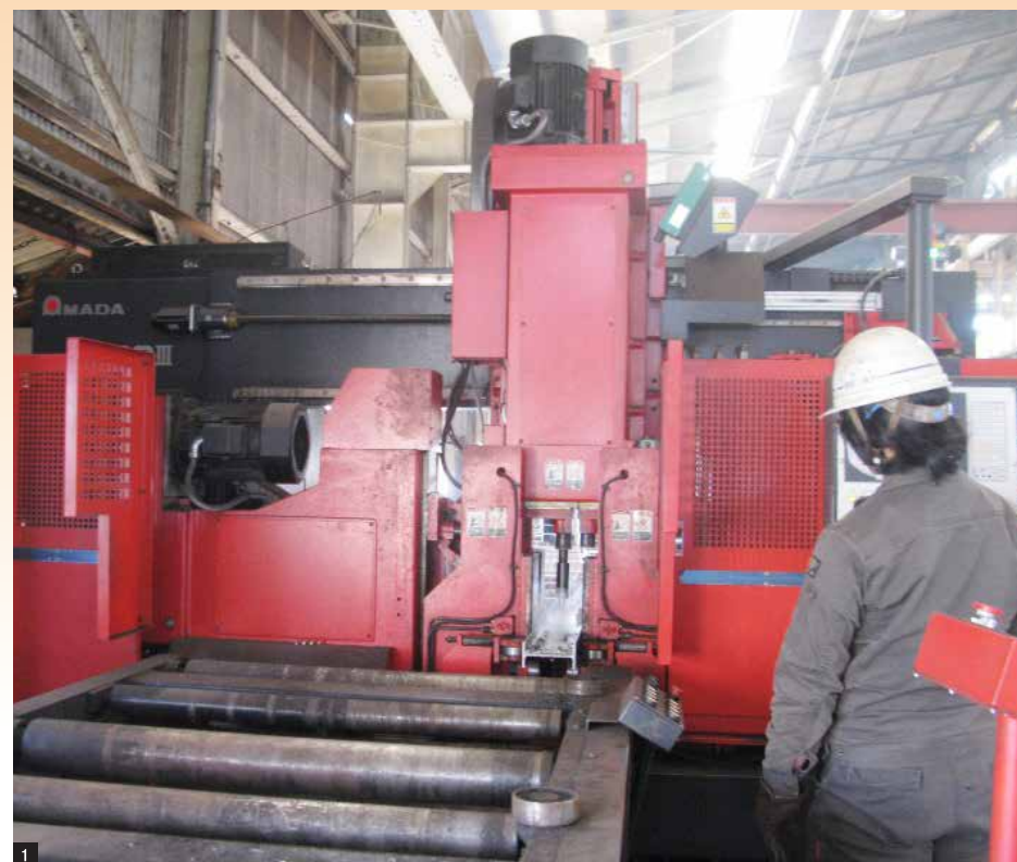
1 導入したH型鋼穴あけ機 2 切断・穴あけ加工した鉄骨製品 3 CADのオペレーターたち
