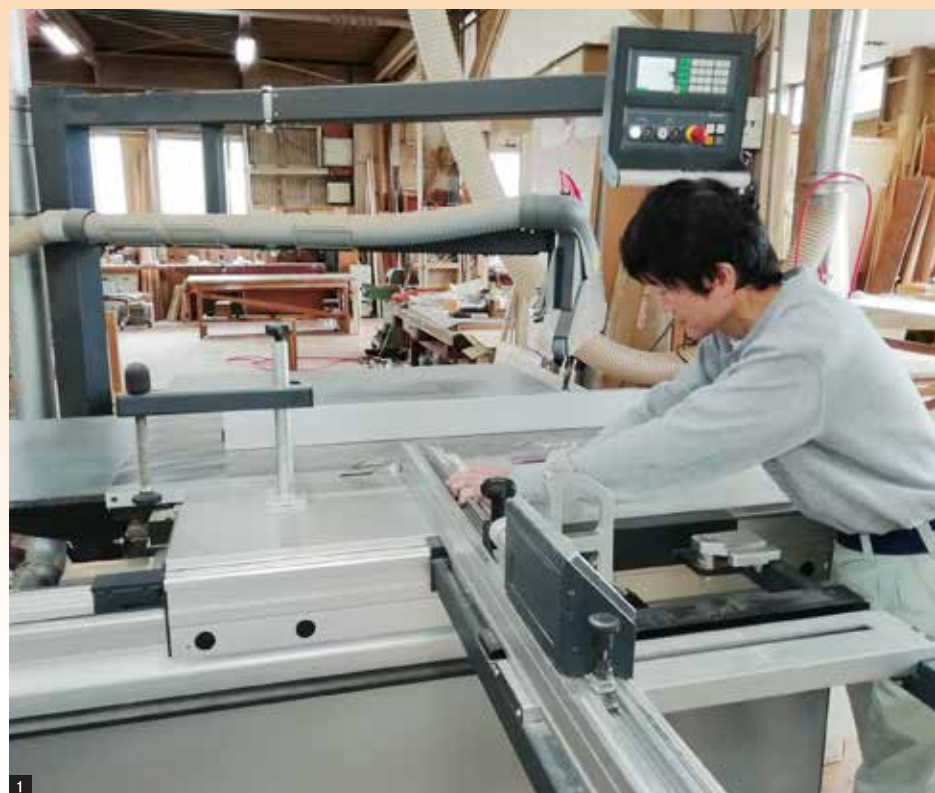
1 スライドソーで木材を高精度にカット 2 フラッシュ工法に欠かせないエッジバンダー 3 完成した建具
