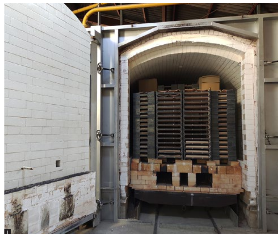
1 最大1350度で高温焼成できるシャトルキルン 2 瓦タイルに釉薬を塗る職人 3 亀谷窯業の瓦は、職人らの高い技術で造られている 4 高級ホテルに採用された瓦タイル
