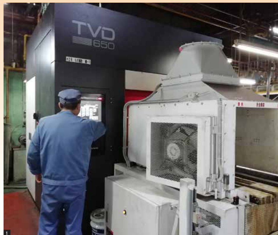
1 導入した真空洗浄機 2 真空炉洗浄 3 社内での作業風景
