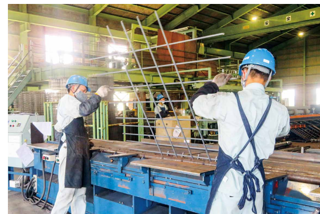
導入した「引張込メッシュ曲機」による作業
