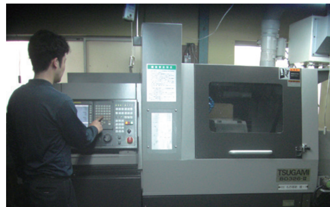
2個のワークを自動加工できる自動盤
