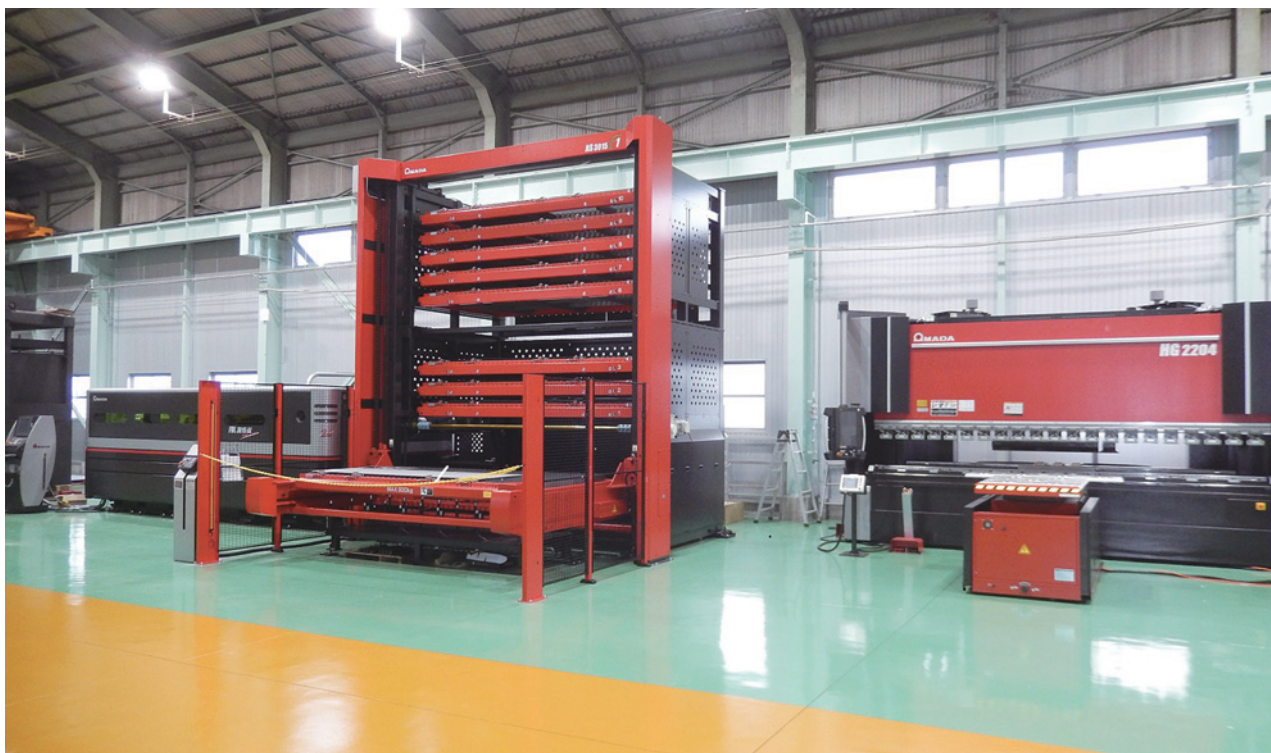
工場内 機械設備（導入機械：大型ベンダーマシンは向かって右側の機械）
