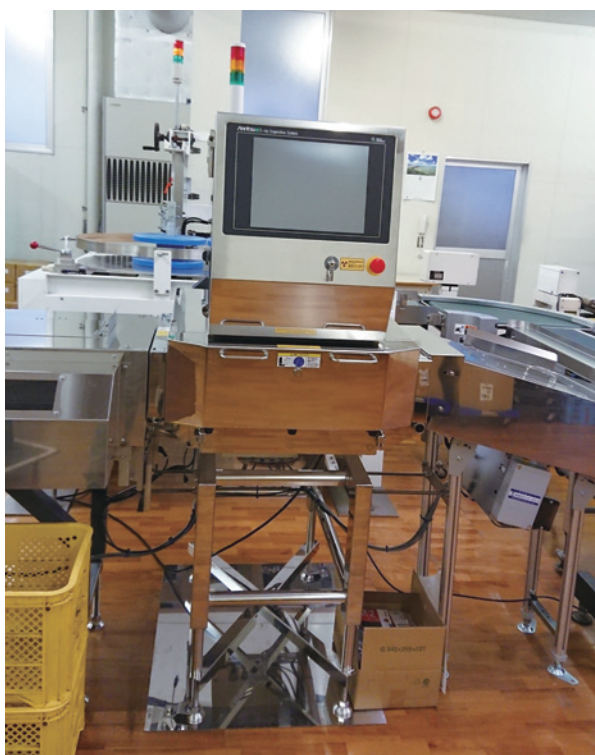
導入設備：X線選別機(左)とメカブ洗浄機
