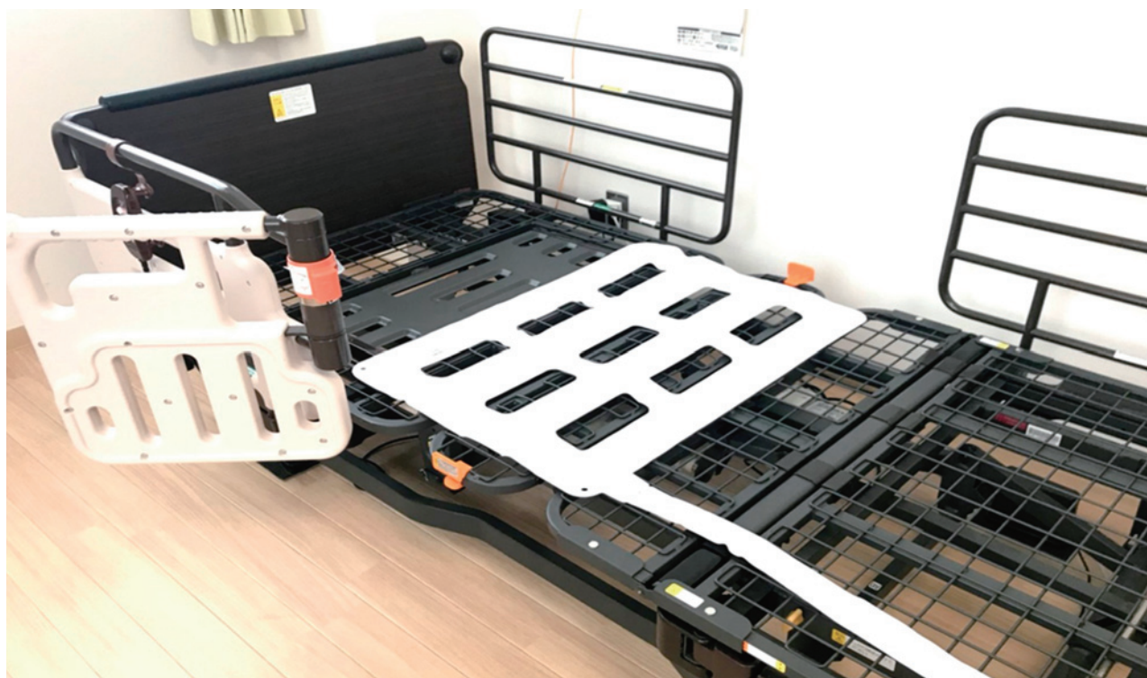
導入設備：aams（見守りセンサー）システム（センサーマット設置状態）
