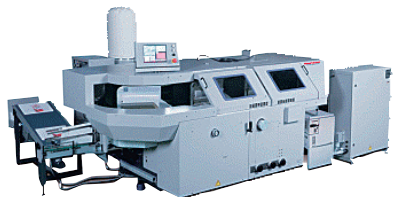
【全自動無線綴機】 製本サイズ B4～A6 処理速度 3,200冊／時
