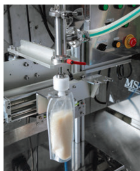
大幅な時間短縮と人員削減を可能にしたスパウトパック充填装置
