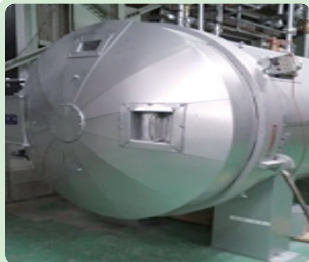
靴本体とゴム底を熱処理固着する加硫缶
