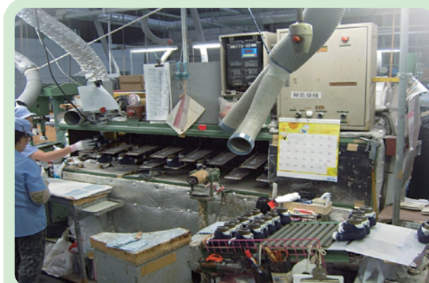
靴成型用糊の乾燥コンベアの様子
