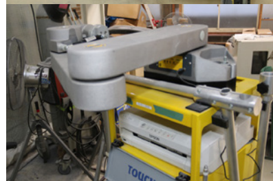
ボディの歪みを計測する「三次元計測機」
