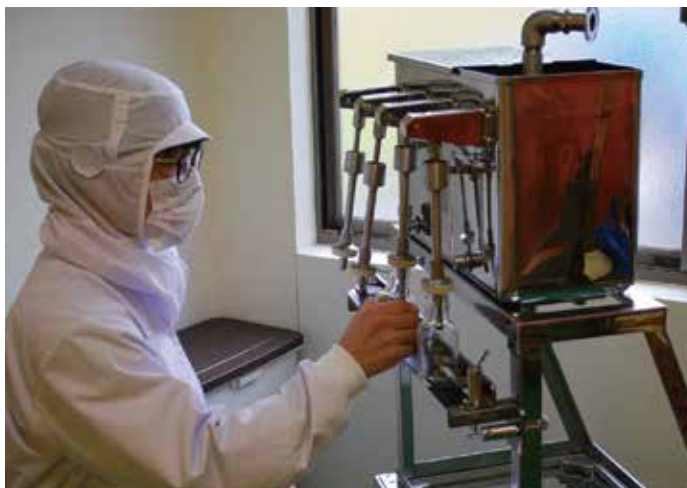
サイホン式5型4本立瓶詰装置
