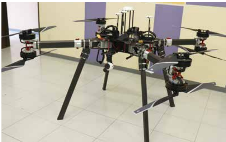
通常のドローンの2倍の羽を有する
