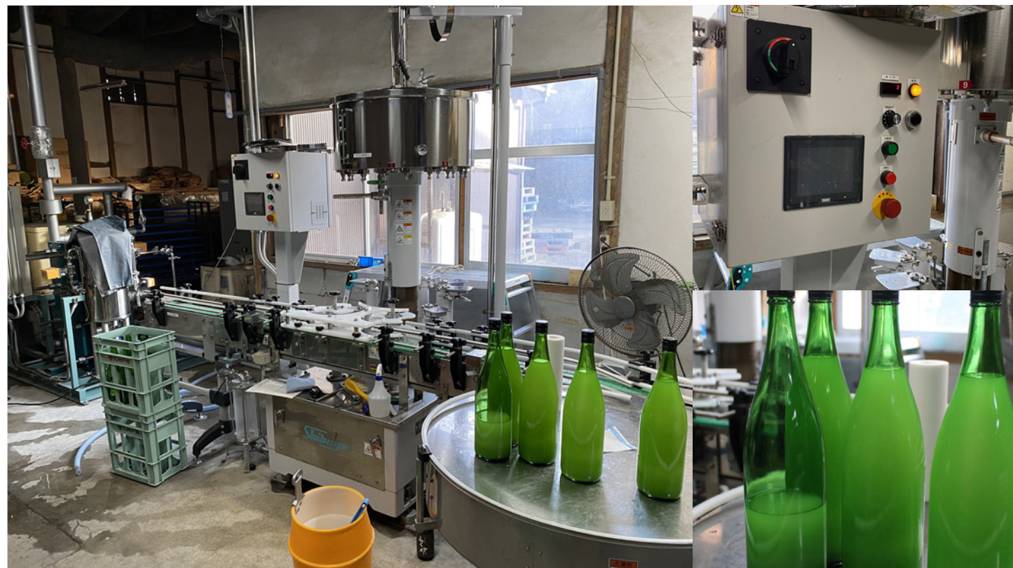
本事業で導入した瓶詰めライン。すべての設備は蔵の1階に集め、作業を効率よく完結できるようにしている
