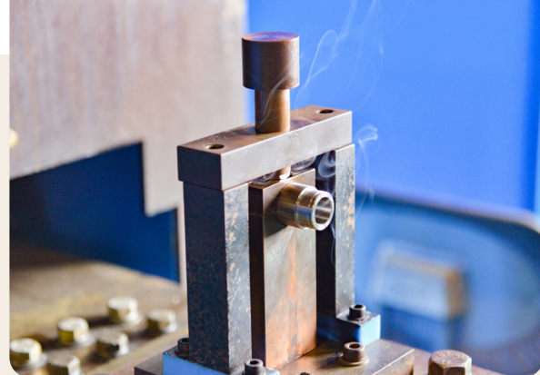
電流を流し材料の電気抵抗の発熱を利用して接合する「フュージョン溶着」。
