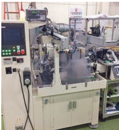
(左上) センタレス研削盤による外径加工 (右上) 上ーピン先端加工前 下ーピン先端加工後 (左下) ピン先研削盤による先端加工 (右下) 完成した小径ピンを組み込んだ精密プレス金型
