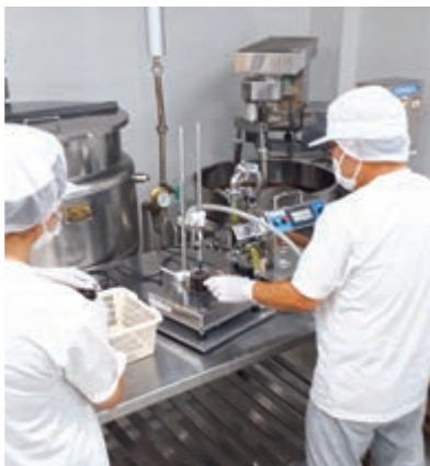
( 上 ) 自動原料処理製麹装置：原料を入れるだけで全自動にて少量(100K)の麹製造が可能 (左下) ハンディ秤充填機：高温のまま迅速かつ正確な容量で衛生的に充填可能 (右下) 蒸気式攪拌釜：液体から粘度の高いものまで焦がさず自動で攪拌可能
