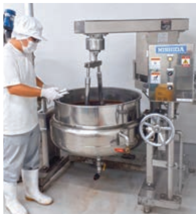
( 上 ) 自動原料処理製麹装置：原料を入れるだけで全自動にて少量(100K)の麹製造が可能 (左下) ハンディ秤充填機：高温のまま迅速かつ正確な容量で衛生的に充填可能 (右下) 蒸気式攪拌釜：液体から粘度の高いものまで焦がさず自動で攪拌可能
