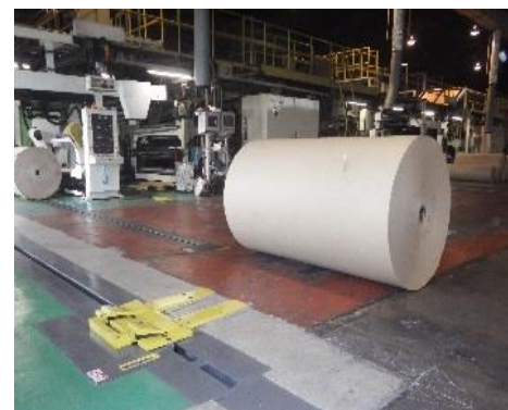
段ボール原紙と 原紙自動搬送ロボットの一部
