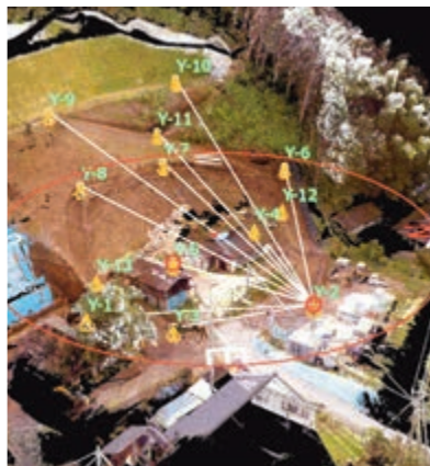
(左上) ドローンと解析ソフトを使用してのデータ作成作業 (右上) 国体会場予定地の造成工事にて3次元レーザースキャナーを使用して測量 (左下) サイテック3Dで3次元データを作成 (右下) マグネットコラージュによる点群生成状況
