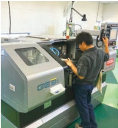
(左上) 加工中 (右上) CNC用汎用円筒研削盤（GE3i） (左下) 作業中 (右下) 加工製品
