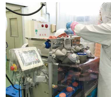
包あん機のタッチパネルで重さ(最大230gまで)を自由にセッティングできる
