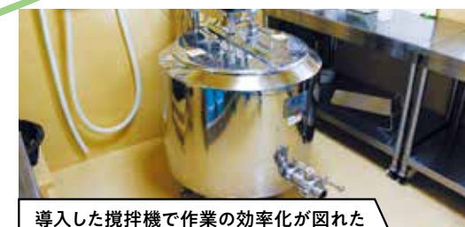
導入した攪拌機で作業の効率化が図れた
